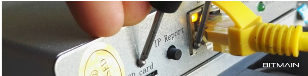
漏电检测图示，测量电压值建议在 1V 以下,超过则需做好接地
