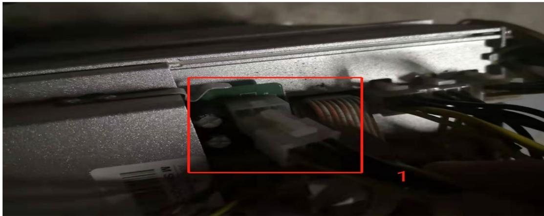
2、检查电源线是否损坏，排除电源线问题；
