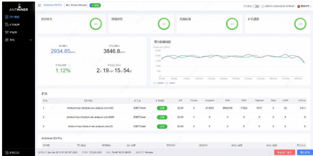
**注意：**E9 Pro 服务器是定频机器，频率为 500 MHz（3680MH/S）。当出风口温度达到 80°C 时，固件将停止运行，并出现错误提示“over max temp, pcb temp（实际温度）”显示在服务器日志页的底部。同时，用户面板界面的服务器温度变为异常并提示“Temp is too high”。
